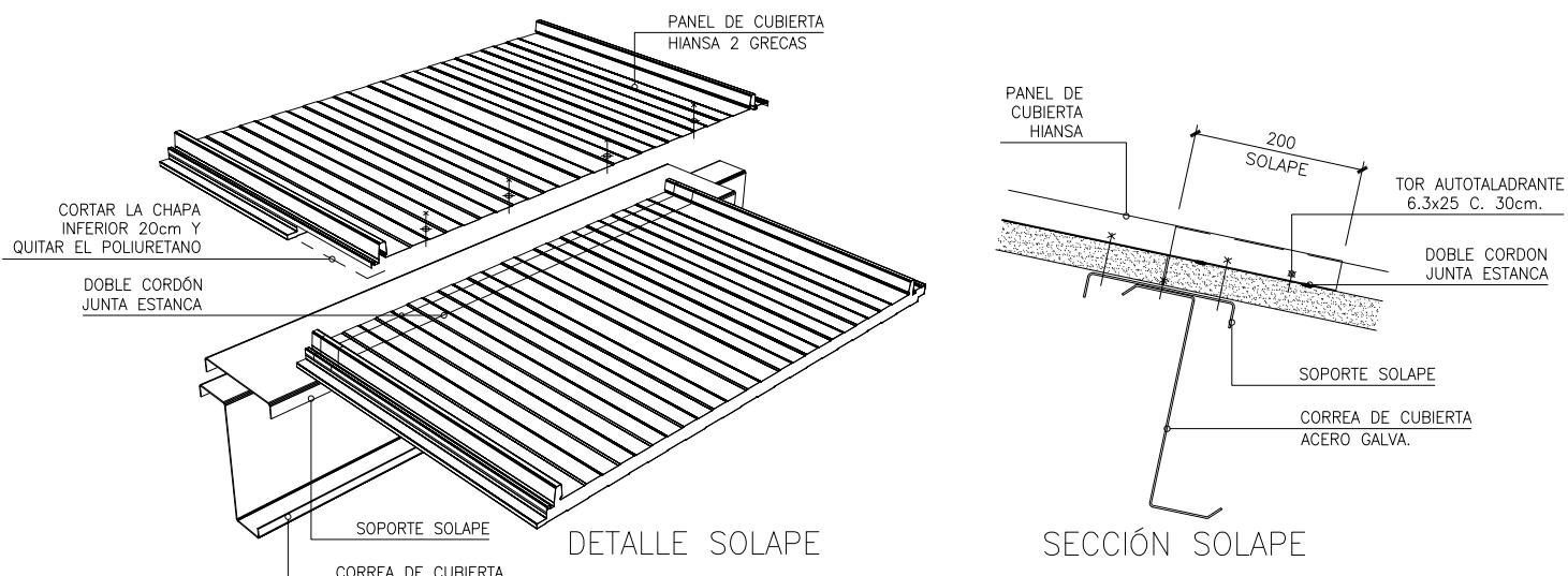
Para resolver el solape entre los tapajuntas del panel, se procederá tal y como indican las figuras siguientes, teniendo en cuenta de no realizar nunca el solape de panel en el mismo punto que el solape del tapajuntas.
